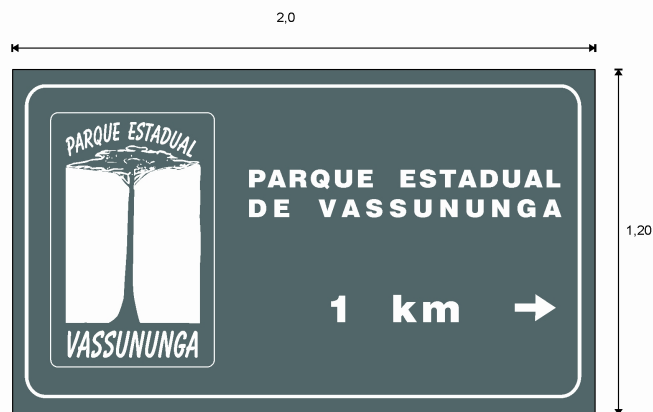
Placa de Acesso Padrão DER para a Rodovia Anhanguera sentido Porto Ferreira Ribeirão Preto
