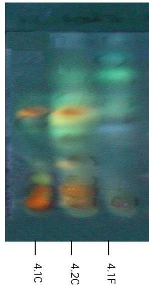
Figura 7: Cromatografia em camada delgada das frações da fase solúvel 4.1F e 4.1C e 4.2C. Eluente: Tolueno: Acetato de Etila: Ácido Fórmico (5:4:1). Revelador: NP-PEG. Observação na luz ultravioleta 250nm.
